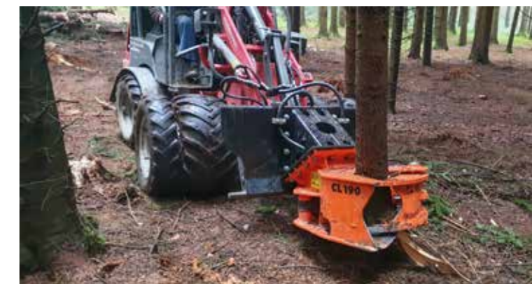
Woodcracker® CL pour bois tendre jusqu'à 40 cm.
