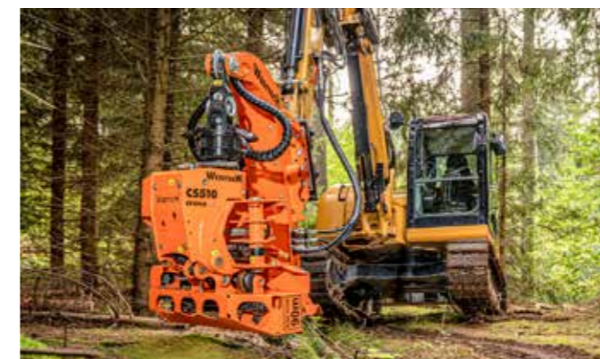
Le pied d'appui permet à la pelle d'avancer quand des outils sont montés en cardanique.
