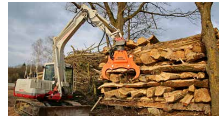
La pré-fente de bois pour un séchage naturel.
