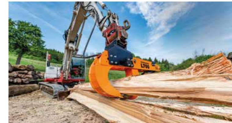
Le tronc peut être fendu et chargé dans le même procédure de travail.
