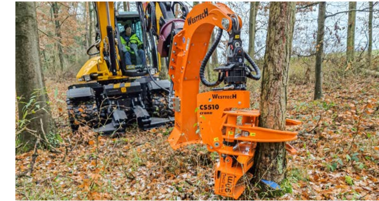
Pied d'appui avec Woodcracker® CS510 crane.
