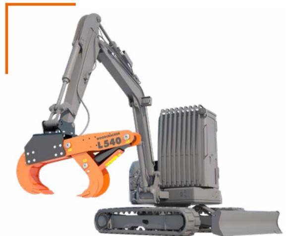
Grâce à la possibilité de montage annexe sur pelle, le tronc peut être fendu et chargé d'une seule manoeuvre.
