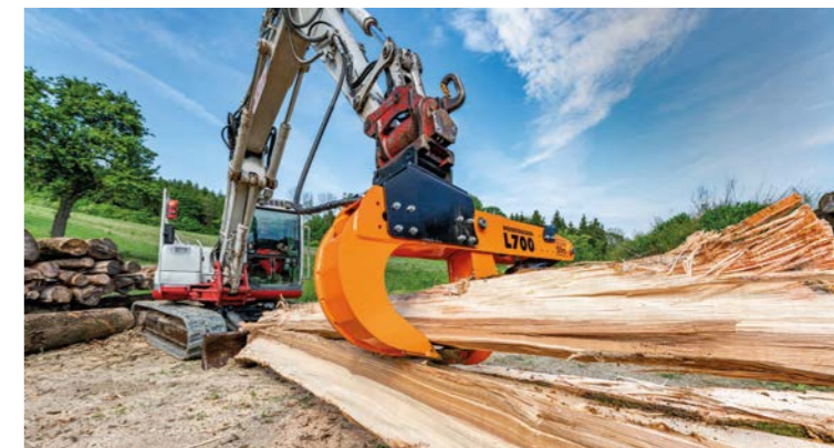
Der Stamm kann in einem Arbeitsschritt gespalten und aufgeladen werden.
