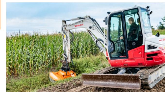
La trinciatrice nella manutenzione delle scarpate.
