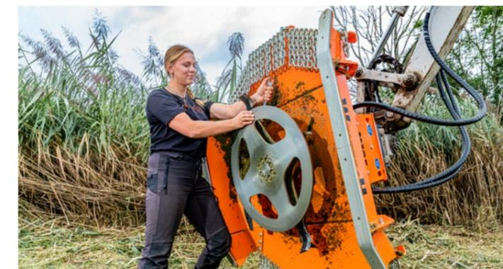
Semplice cambio della lama, pattini di usura sostituibili.
