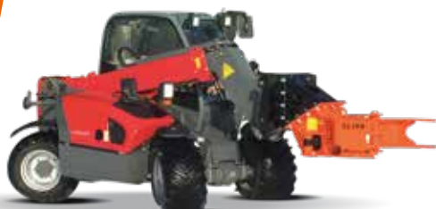
Woodcracker CL190 eignet sich auch für den Hoflader-/Hoftrac-Anbau.
