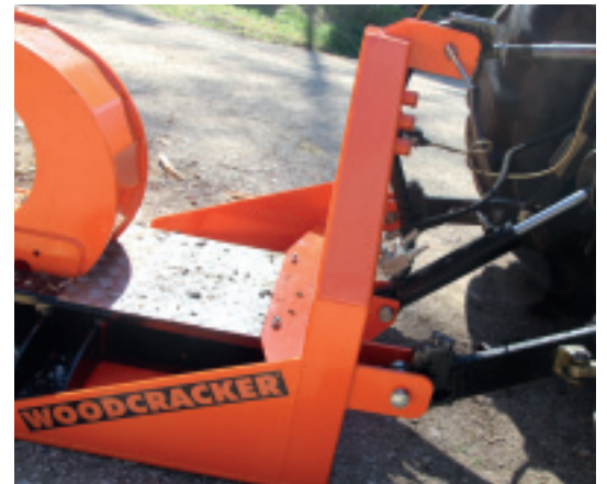
Der Hydraulikstempel fixiert die Westtech-Spaltzange sicher am Boden, ...
