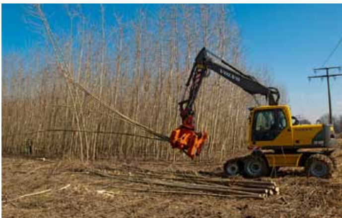
Die etwas kleinere Variante: Der Schneidkopf Woodcracker C350 schafft Durchmesser bis 35 cm
