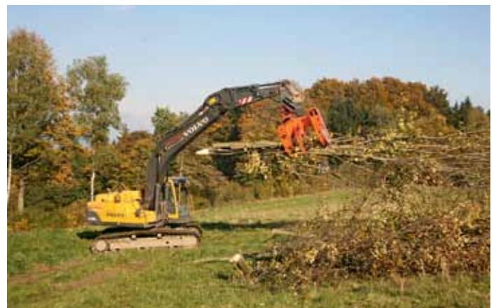
Neu im Programm von Westtech: Der Woodcracker C450 ist auf Bagger mit 20 bis 25 t Dienstgewicht ausgelegt
