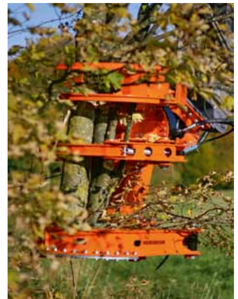
Der Schneidkopf Woodcracker C450 schafft Durchmesser bis 45 cm
