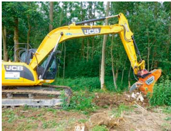
Experte für Wurzelstockrodung: Die Rodeschere R1200 verfügt über eine Öffnungsweite von 1200 mm
