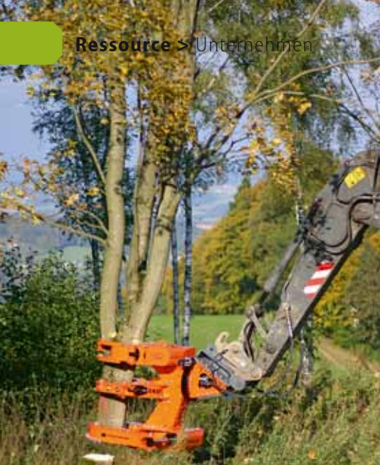
Der Woodcracker C450 in Aktion: Er schneidet Bäume bis 45 cm Durchmesser
