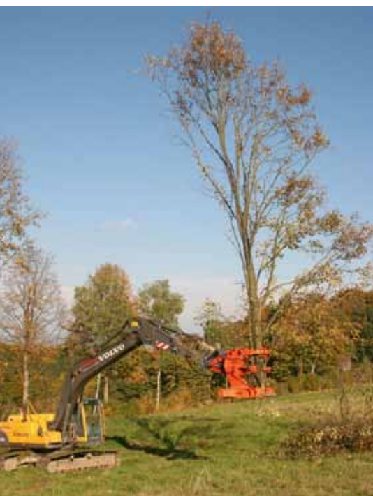
Vorteile des C450: Das Erntegut wird gehalten und kontrolliert beiseitegelegt
