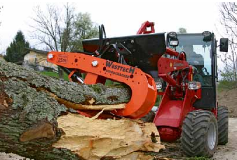
Die Maschine fürs Grobe: Der L540 „ecoline“ weist eine Zangenöffnung von 450 mm auf
